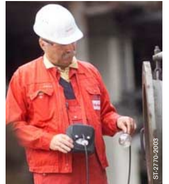
Dräger X-am 7000: Kapalı alan ölçümleri için güçlü dahili pompa.
