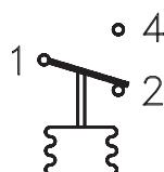
**REMARQUE - Il existe deux modes de fonctionnement du pressostat : l'un en tant que pressostat dédié à la montée en pression et l'autre en tant que pressostat dédié à la diminution de la pression. À des fins d'identification, une description appropriée est apposée au bas du boîtier (voir les exemples ci-dessous).**
