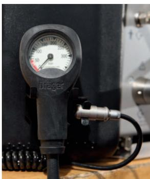
Painemittarin / Dräger Bodyguardin ja mikrofonin sijoitus testauksen aikana
